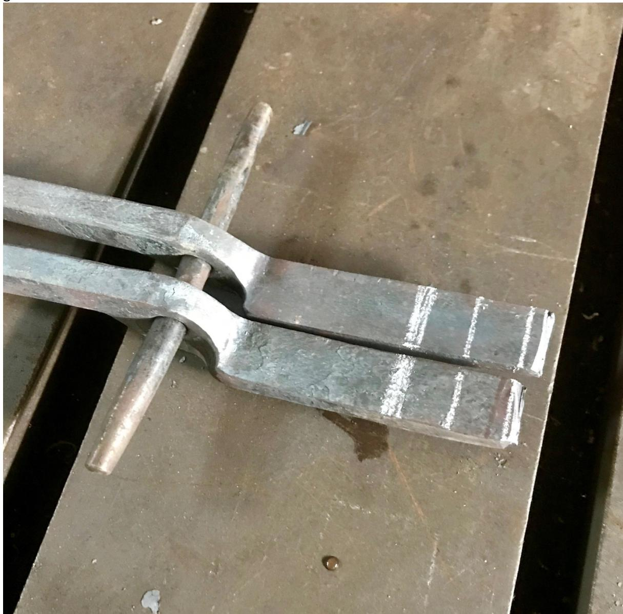
**Schritt 2:** Das Maul rund 12mm einschlitzen (mit dem Meißel oder mit der Flex) und 25mm vom Ende eine Markierung setzen
