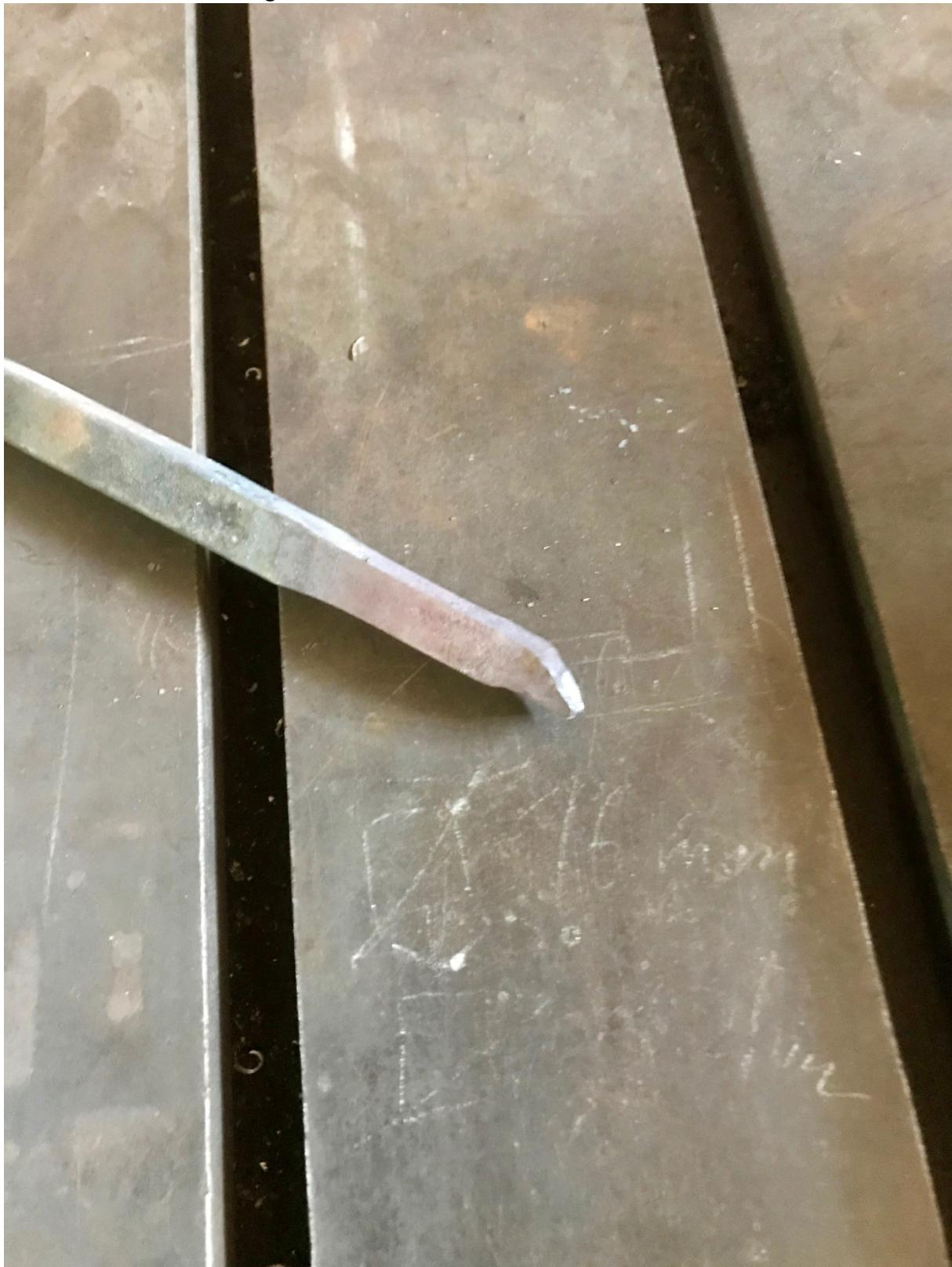
**Schritt 2:** 10mm Rundstab anstauchen bis ein 12mm Vierkant entsteht und ebenfalls für die Schweißung vorbereiten.
