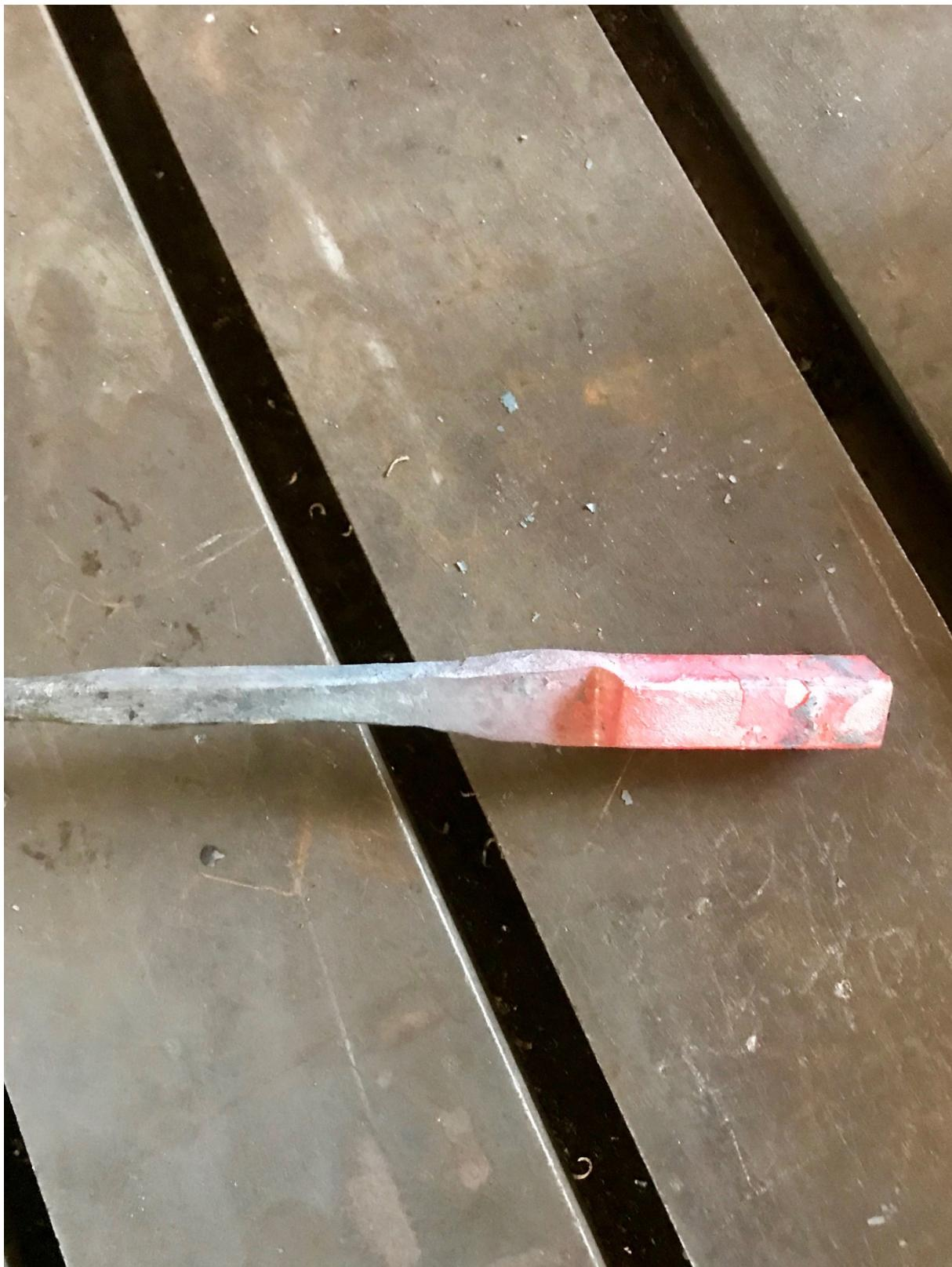
**Schritt 5:** Das abgesetzte Material zum Schenkel hin erneut absetzen.
