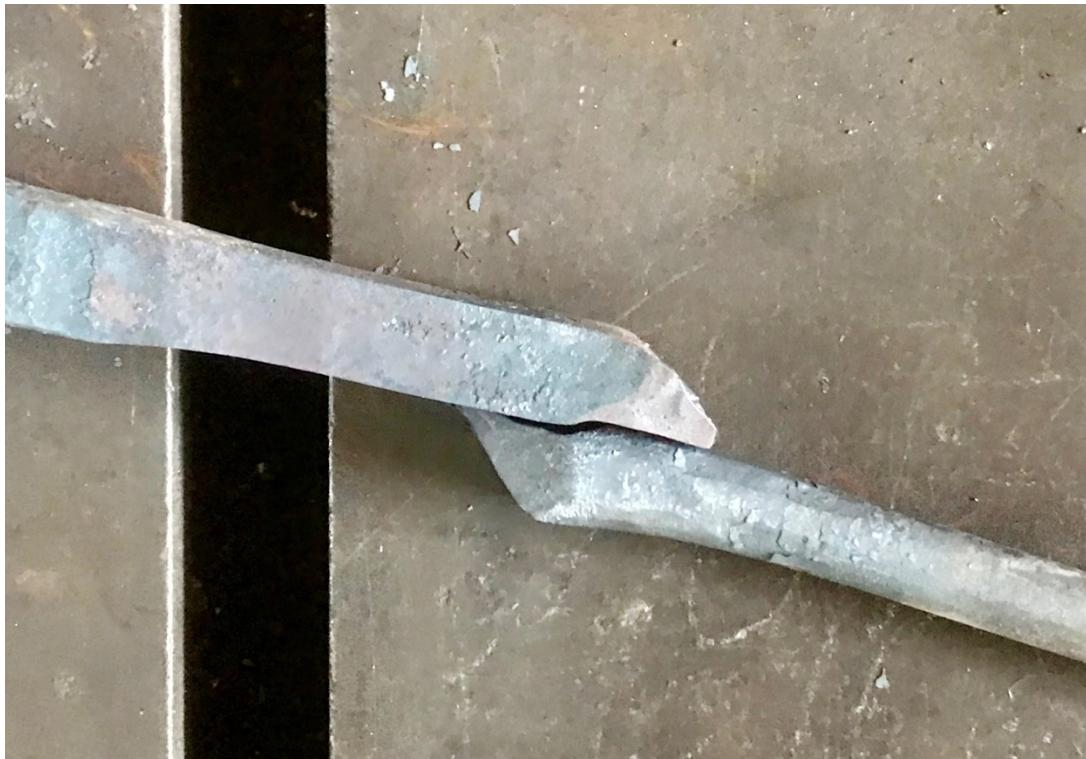
Verschweißte Teile: von links nach rechts: 16mm Vkt. -->12mm Vkt. --> 10mm rund
