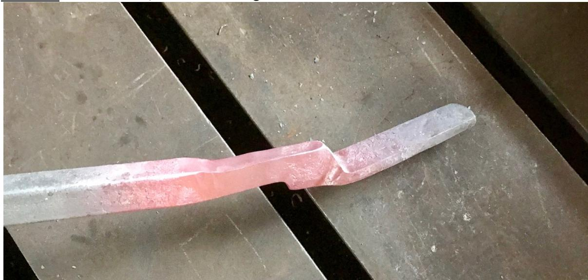
**Schritt 4:** Schenkel ausschmieden. Entweder unterm Maschinenhammer oder mit etwas Geduld am Amboss. Ziel ist ein 10mm Rundstab als Griff und ein 12mm Vierkant als oberes Schenkelende
