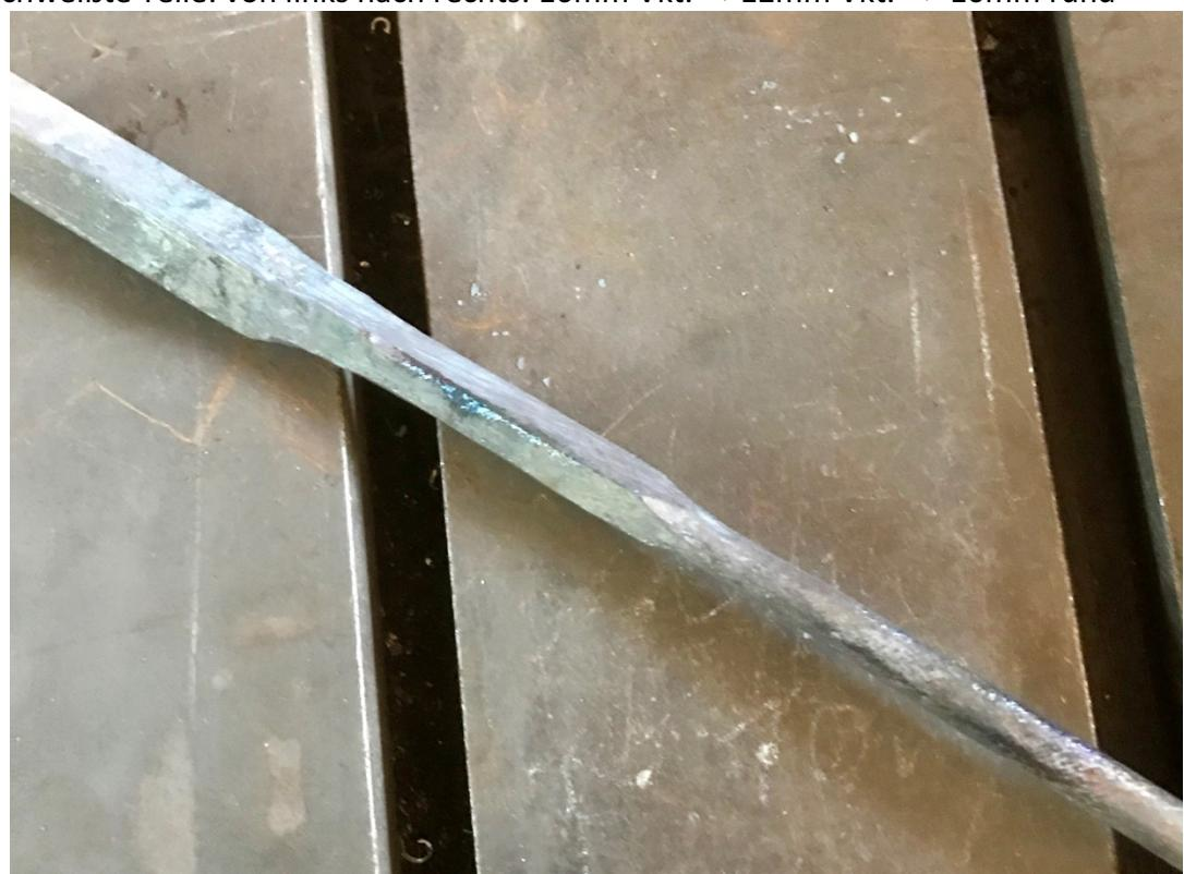
**Schritt 4:** Den 16mm Vierkant auf eine Stärke von 12mm absetzen. Das Material ist nach der Schweißung abgelängt worden.
