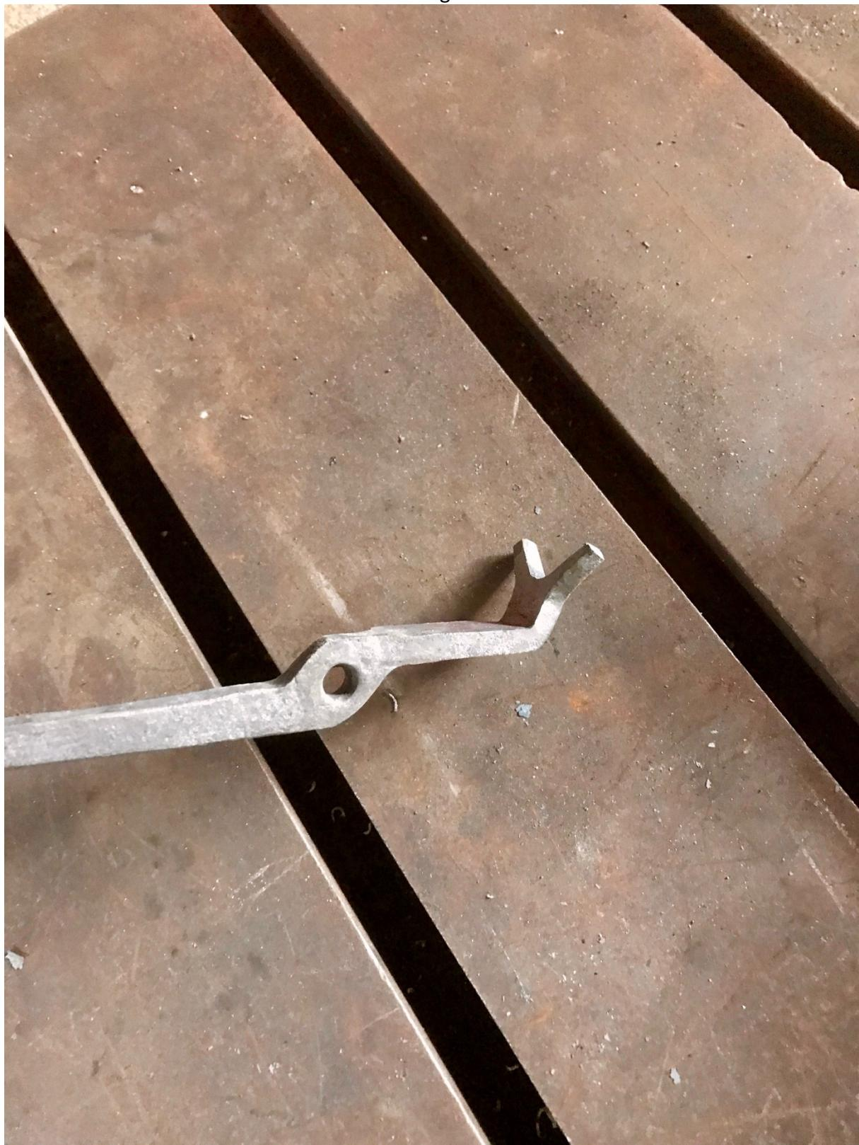
**Schritt 5:** Die zweite Biegung kurz dahinter biegen. Alle Biegungen nochmals richten. Die Zähne müssen so stehen, dass sie sich beim Schließen der Zange zuerst berühren (vgl. Schritt 6).
