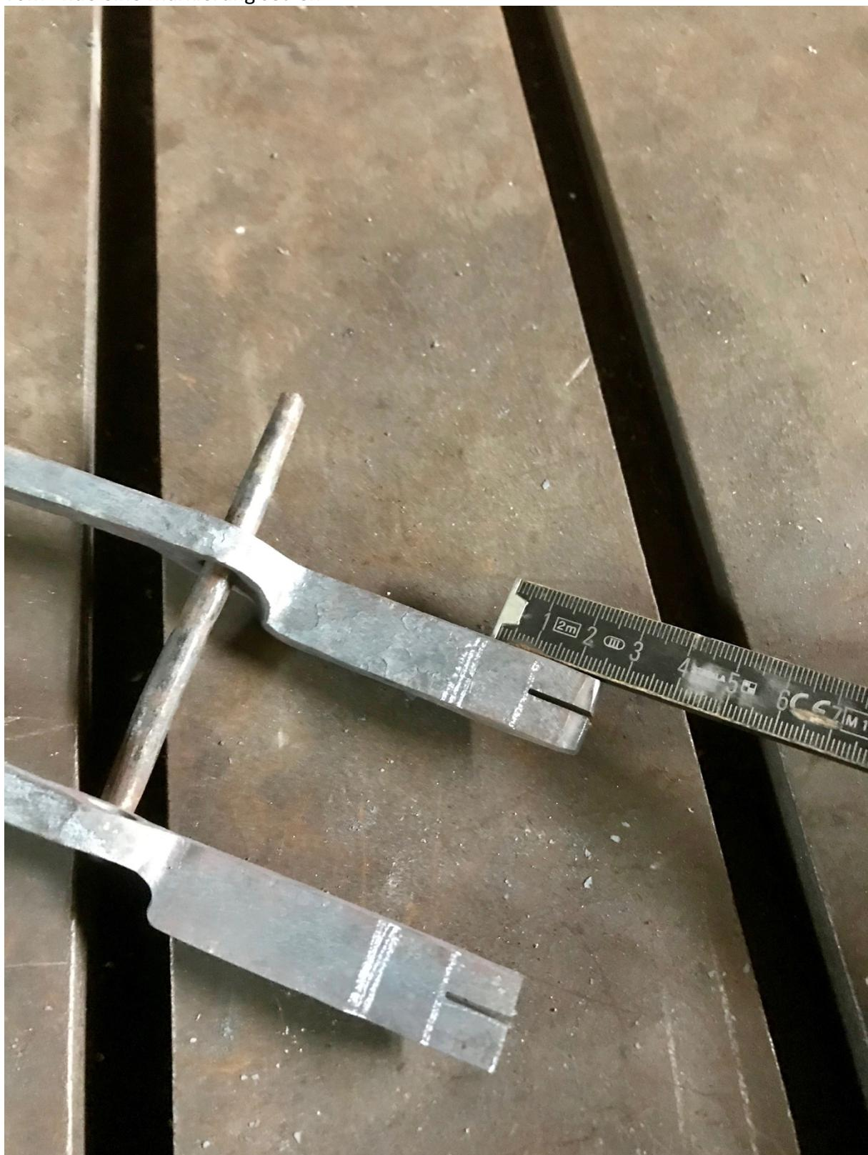
**Schritt 3:** Das Ende aufspalten und die „Zähne“ Etwas länger ausschmieden.
