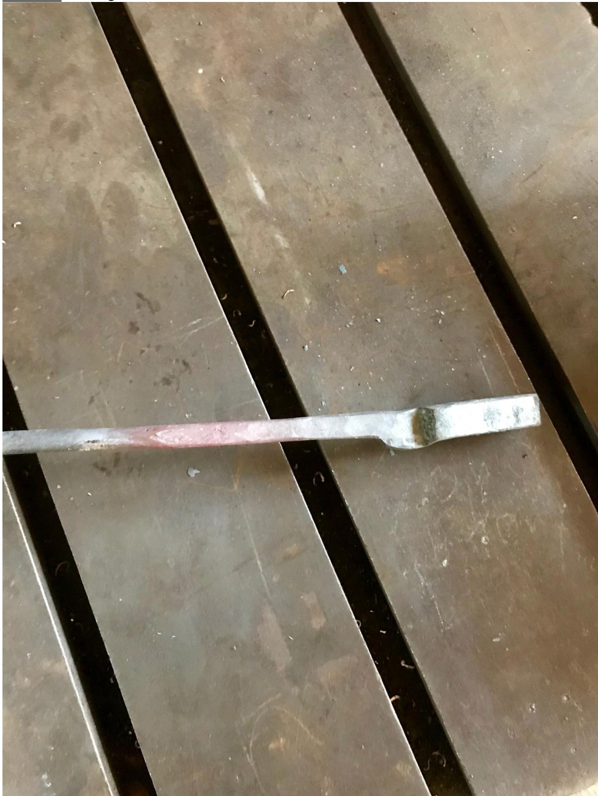
**Schritt 6:** Auf der gegenüberliegenden Seite den dritten Absatz schmieden. Das Maul wird geformt.
