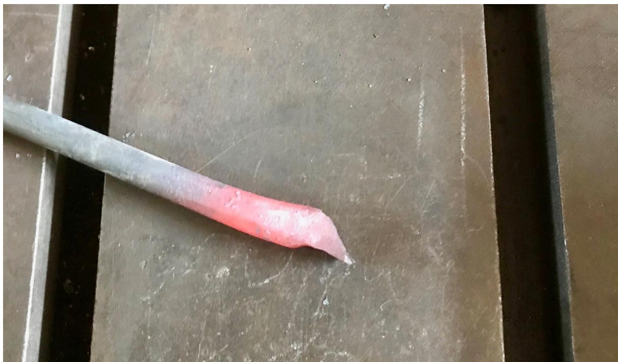
**Schritt 3:** Die Feuerschweißung durchführen. Die Teile müssen vorbereitet sein und gut aufeinanderpassen. Wenn beide Teile die Schweißtemperatur erreicht haben werden beide Teile auf den Amboss gelegt und das untere Teil wird mit dem oberen gehalten. Mit leichten schnellen Schlägen verschweißen. Mehrere Schweißhitzen durchführen um die Naht vollends verschwinden zu lassen.
