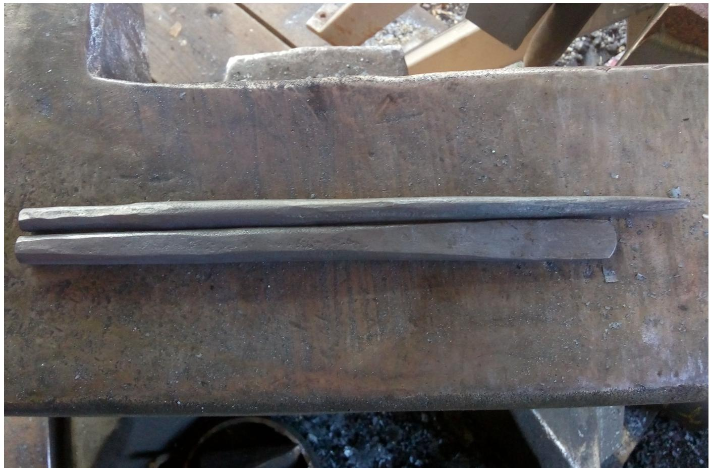
Anschließend muss das Werkzeug noch geschliffen werden. Grober Zunder und Schlackereste sollten vorher schon mit der Drahtbürste entfernt worden sein.
